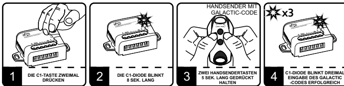
Abb. 4. Eingabe des Bestätigungscodes zum Funkempfänger.
