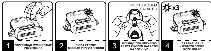
Rys. 4. Wprowadzenie kodu uwierzytelniającego funkcji Galactic do odbiornika.
