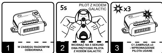
Rys. 5. Wpisywanie pilota z funkcją Galactic do odbiornika
